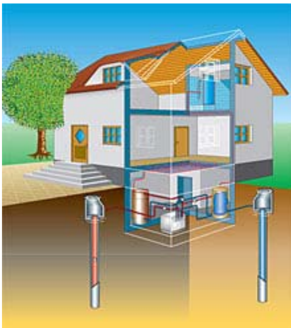
Abb. 6 > Prinzipielle Darstellung einer Grundwasser-Wärmepumpenanlage
